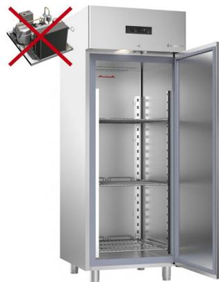
Armoire frigorifique réalisé avec structure monocoque interne et externe en acier inox AISI 304. Chambre de conservation avec crémaillères en acier inox AISI 304, 21 niveaux. Système de refroidissement ventilé, évaporateur positionné à l'extérieur du compartiment de conservation. Panneau de commandes avec thermostat - thermomètre digital. Dégivrage électrique. En dotation chaque compartiment : n. 3 paires des guides en acier inox AISI 304 et n. 3 grilles plastifiées.
