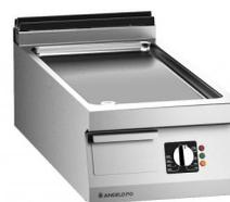
Disponibile solo per i paesi al di fuori della Comunità Europea. Fry-top realizzato in acciaio inox AISI 304, spessore piano di lavoro 20/10 mm. Piastra di cottura in acciaio Fe510D satinato. SISTEMA COOKING PRO. In dotazione: tappo piastra. Riscaldamento tramite resistenze sottopiastra in acciaio inox AISI 309, termostato di sicurezza. Temperatura di lavoro (min-max): 70-260°C. Predisposizione per il controllo remoto del taglio di picco.
