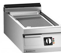
Fry-top realizzato in acciaio inox AISI 304, spessore piano di lavoro 20/10 mm. Piastra di cottura in acciaio Fe510D, trattata al cromo duro. SISTEMA COOKING PRO. In dotazione: tappo piastra. Riscaldamento tramite resistenze sottopiastra in acciaio inox AISI 309, termostato di sicurezza. Temperatura di lavoro (min-max): 70-260°C. Predisposizione per il controllo remoto del taglio di picco.
