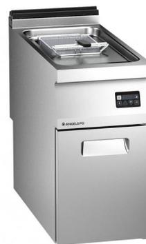
Friggitrice realizzata in acciaio inox AISI 304, spessore piano 20/10 di mm. Vasca stampata integrata al piano, a tenuta, con ampie raggiature e zona di decantazione; in dotazione per vasca: 1 cestello e 1 coperchio. Comandi digitali. Scheda elettronica per controllo e visualizzazione temperatura 0-190°C, programma di melting e mantenimento a 100°C, allarme sonoro. Resistenze ribaltabili all' interno della vasca. Predisposizione per il controllo remoto del taglio di picco di potenza.
