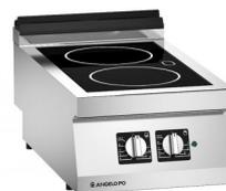
Cucina con piano in vetroceramica realizzata in acciaio inox AISI 304, spessore piano di lavoro 20/10 mm. Piano di cottura con vetroceramica, inserito a filo e sigillato a tenuta di liquidi. Riscaldamento tramite resistenze ad infrarosso. 2 zone di cottura indipendenti comandate da regolatore di energia.
