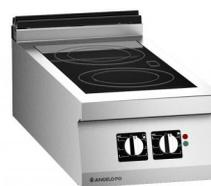
Cucina con piano in vetroceramica realizzata in acciaio inox AISI 304, spessore piano di lavoro 30/10 mm. Piano di cottura con vetroceramica, inserito a filo e sigillato a tenuta di liquidi. Riscaldamento tramite resistenze ad infrarosso. 2 zone di cottura indipendenti comandate da regolatore di energia. Predisposizione per il controllo remoto del taglio di picco di potenza.
