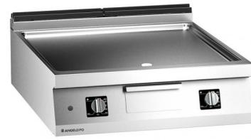
Disponibile solo per i paesi al di fuori della Comunità Europea. Fry-top realizzato in acciaio inox AISI 304, spessore piano di lavoro 20/10 mm. Piastra di cottura in acciaio Fe510D satinato. In dotazione: tappo piastra. Riscaldamento tramite due batterie di bruciatori indipendenti comandati da valvola termostatica ad azione modulante. Temperatura di lavoro (min-max): 120-320°C.
