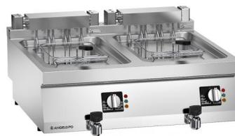
Friggitrice realizzata in acciaio inox AISI 304, spessore piano 20/10 di mm. Vasche stampate integrate al piano, a tenuta, con ampie raggiature e zona di decantazione; in dotazione per vasca: 1 cestello e 1 coperchio. Comandi meccanici. Controllo temperatura con termostato 100-190°C. Resistenze ribaltabili all'interno della vasca.
