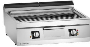
Fry-top realizzato in acciaio inox AISI 304, spessore piano di lavoro 20/10 mm. Piastra di cottura in acciaio Fe510D, trattata al cromo duro. SISTEMA EVEN-PRO. In dotazione: tappo piastra. Riscaldamento tramite due batterie indipendenti di resistenze sottopiastra in acciaio inox AISI 309, termostato di sicurezza. Temperatura di lavoro (min-max): 70-260°C.
